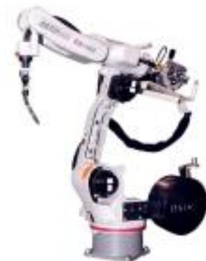
Robô para soldagem elétrica
