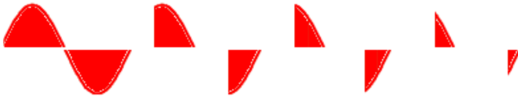
Rampa de Tensão na Parada
