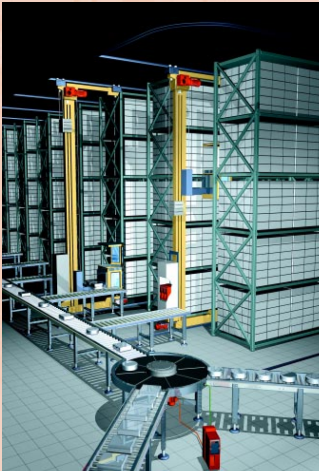
Figura 14 - Transelevador com servo-acionamento Sew.
