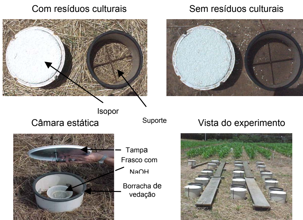
Figura 3. Vista das câmaras estáticas da medição de emissão de C-CO 2 .
