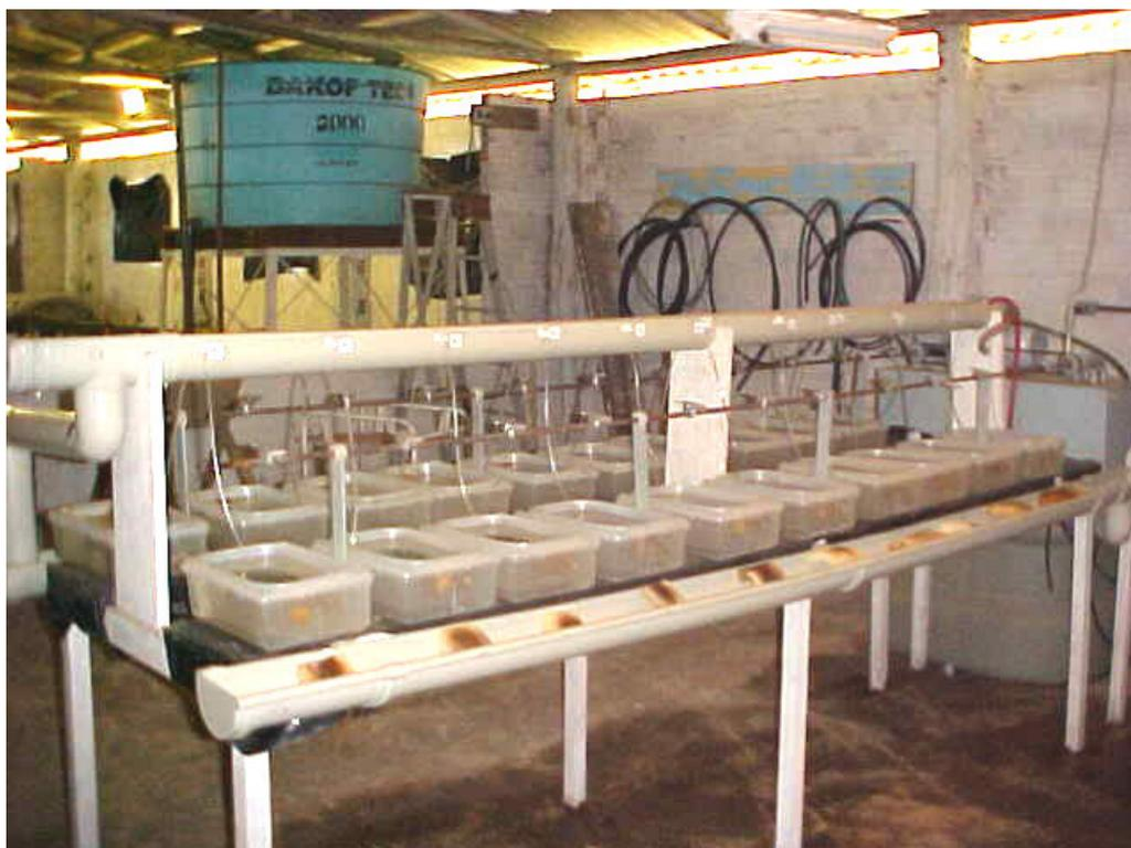
**Figura 03** – Sistema de criação de pós-larvas do Laboratório de Nutrição do Setor de Piscicultura da UFSM.
