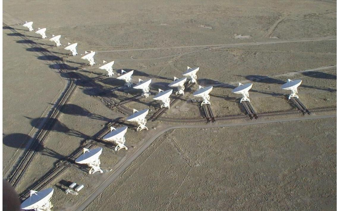
Very Large Array (VLA): Interferometria com 27 antenas de 25 m de diâmetro cada
